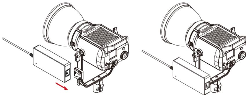
5 连接电源线进行供电。
