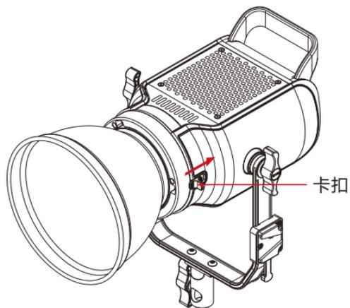
**4** 将适配器安装到灯电源V扣上。
