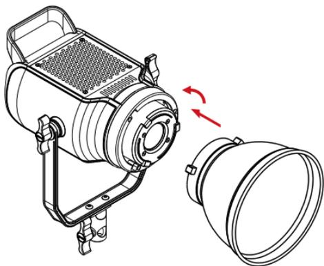
**3** 将卡扣往后推，同时逆时针旋转聚光罩。便可将聚光罩拆卸。
